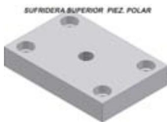
En el centro geométrico de la placa, taladraremos con varias brocas hasta conseguir un orificio de 10,25 mm, para ser roscado a M-12/175, y montar la muñequilla que centrará (y en este caso de troquel pequeño, sujetará) el conjunto a la prensa excéntrica.
